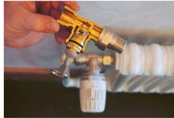
Während Ventileinsätze von herkömmlichen Thermostaten nicht eingestellt werden können, ist dies bei voreinstellbaren Thermostaten möglich. So kann der Durchfluss des warmen Wassers in den Heizkörper begrenzt und an den tatsächlichen Bedarf des Raumes angepasst werden.
