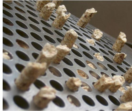
↑ Holzspäne werden durch eine Matrize gepresst – so entstehen Pellets.
